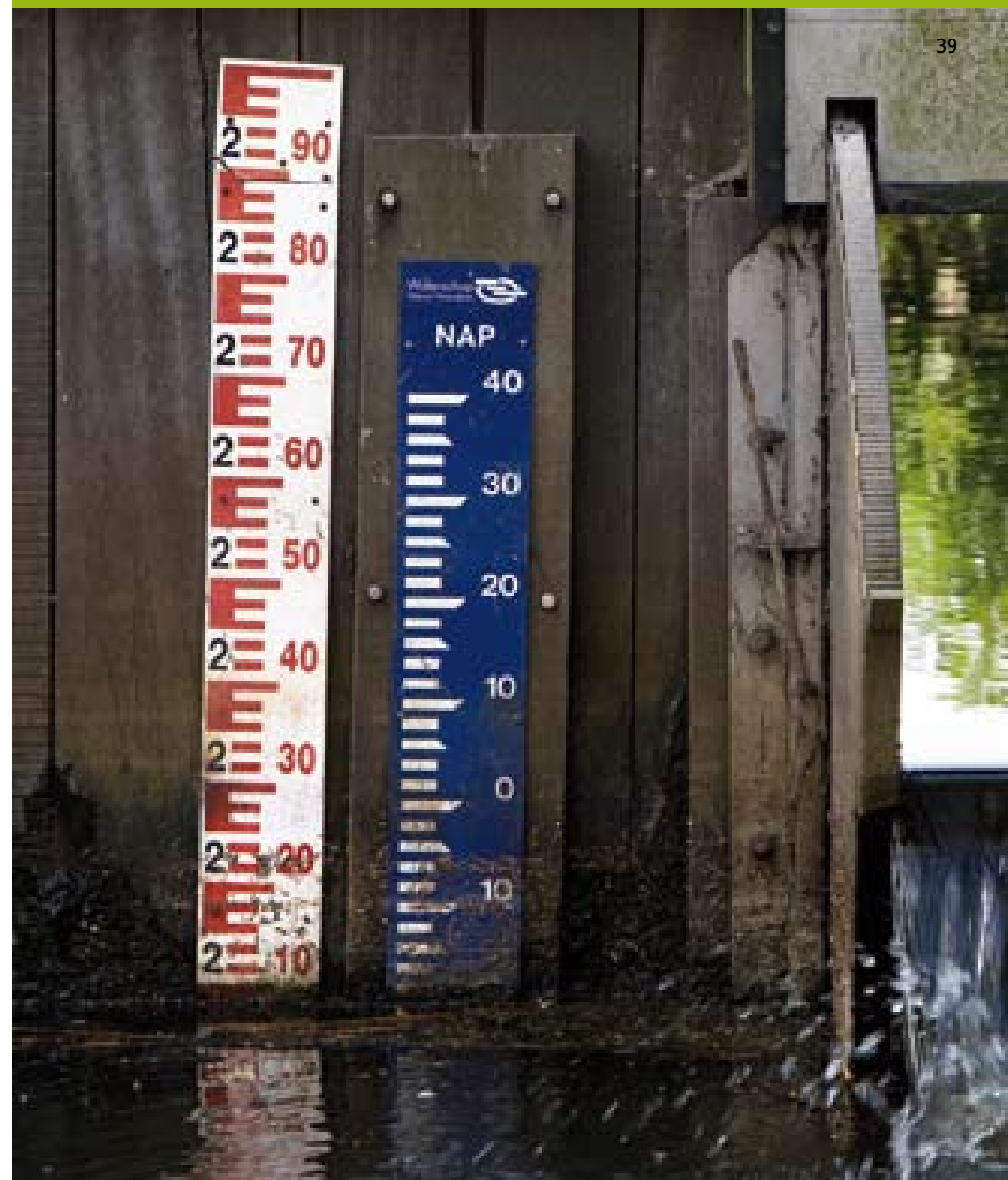
Belgische peilschaal naast een Nederlandse NAP-schaal
