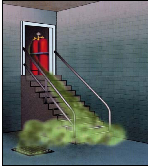
Afb. 2.3: Verspreidingsgedrag van vloeibaar gemaakte gassen (voorbeeld). 4
