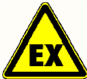
Afb. 4.3: Waarschuwbord ter markering van explosiegevaarlijke plaatsen.
